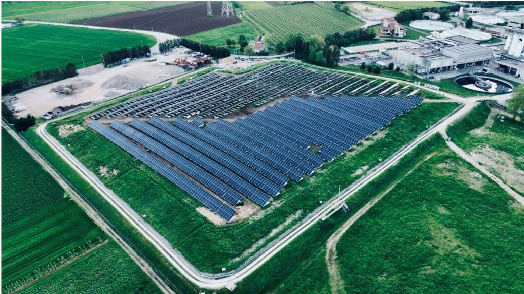
È ormai in fase di completamento a Montorso l'impianto fotovoltaico che avrà un totale di **2,4 megawatt di picco (MWp)** generati da circa 11.500 metri quadrati di pannelli solari, una superficie pari a circa due campi da calcio. L'energia prodotta, in grado di soddisfare il fabbisogno energetico equivalente al consumo domestico annuo di elettricità (circa 3 MWh) di oltre 830 famiglie di 4 persone, sarà interamente utilizzata per alimentare il depuratore di Arzignano.
